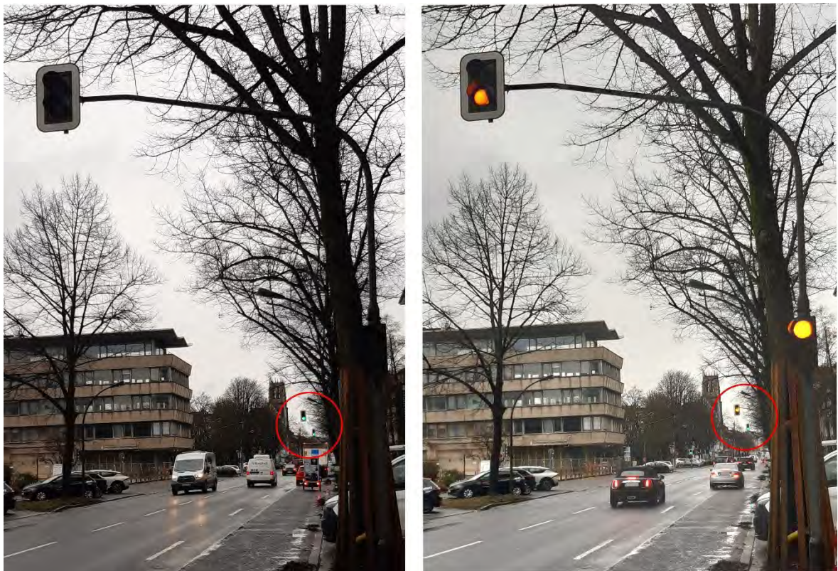
Abbildung 14: Vorsignalisierung zur Lichtsignalanlage (LSA) – Symbolbild Bild links: Vorsignal aus, die nächste LSA wird mit der Grünphase erreicht Bild rechts: Vorsignal gelbes Blinklicht, an der nächsten LSA ist „Halt“ zu erwarten.
