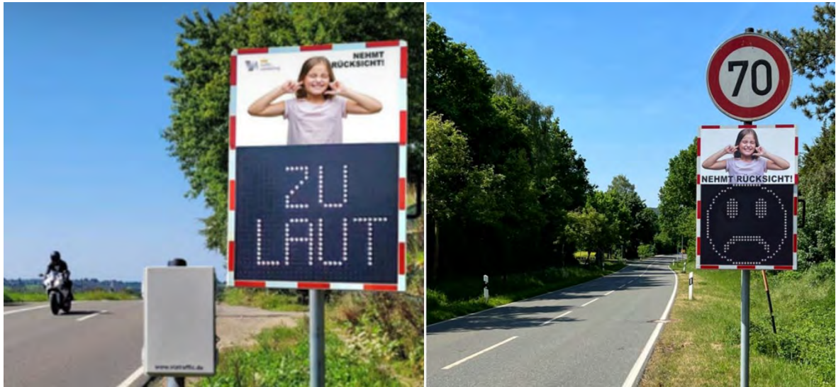
Abbildung 15: Dialog-Displays: Beispiele für Lärmdisplay – Symbolbild (Quelle Fotos: "via NRS Lärmdisplay" – Website der via traffic controlling gmbh, Campusallee 1, 51379 Leverkusen)
